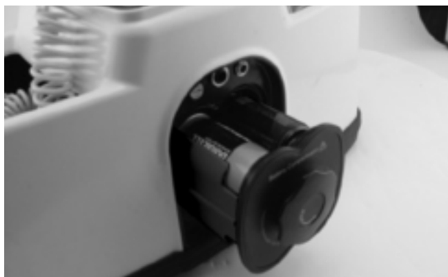
Рис. 6 – извлечение аккумуляторного отсека
