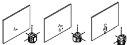
Рис. 9 - Самопроверка 3-х горизонтальных лучей лазера
