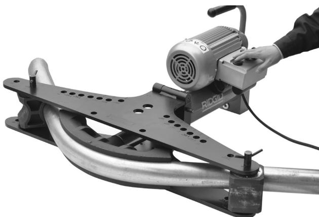
**Рис.14 - Работа на электрической гибочной машине**
