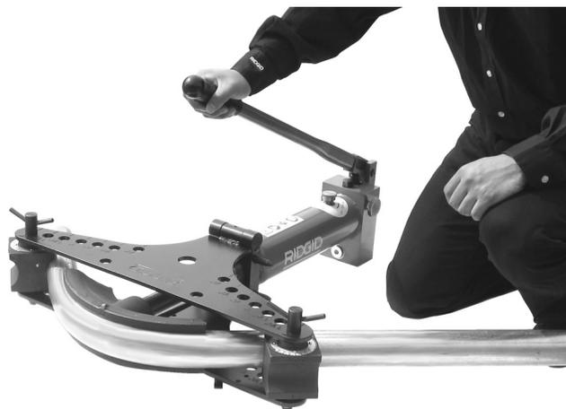
**Рис.13 - Работа на ручной гибочной машине**
