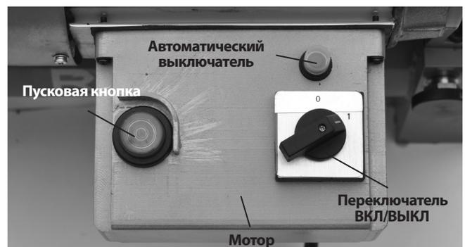
Рис.11 – Средства управления мотором
