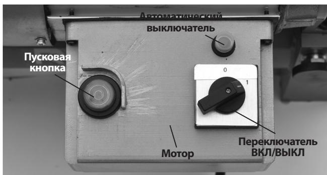
**Рис.8 – Средства управления электрической гибочной машины**
