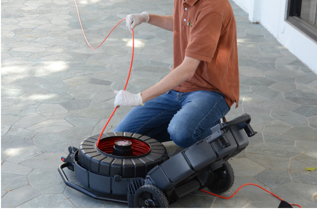
Рисунок 26 – Вращайте барабан, чтобы правильно намотать проталкивающий кабель
