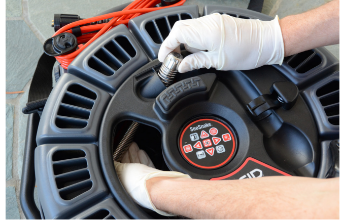
Рисунок 28 – Укладка головки камеры
