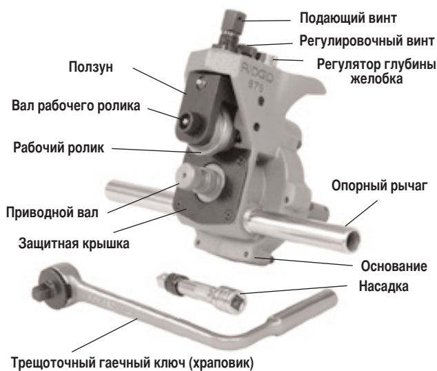
Рисунок 1 – Устройство для накатки желобков 975 Combo
