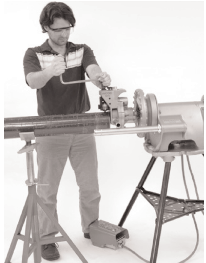
Рисунок 12 – Рабочая позиция устройства для прокатки желобков
