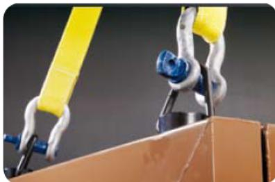
Использование четырех подъемных колец помогает следить за центром тяжести при грузоподъемности до 1100 кг общего веса и гарантировать безопасность, в отличие от подъемной системы с двумя кольцами/брусом.
