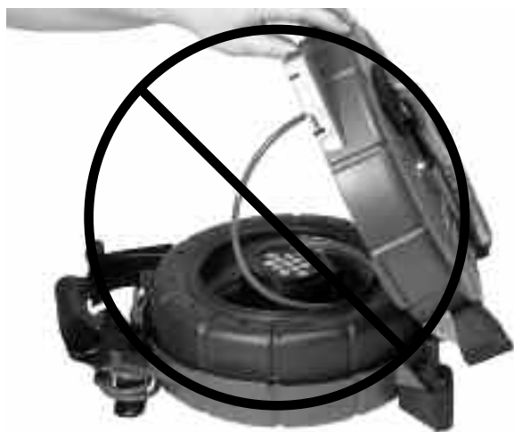
Рис. 10 – Не допускайте самопроизвольного разматывания кабеля
