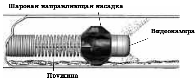
Рис. 24 – Положение шаровой направляющей насадки при работе
