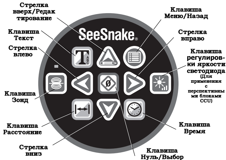
Рис. 20 – Дополнительная клавиатура CountPlus
