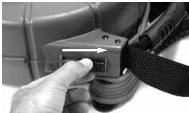
Рис. 4 – Освобождение защелок корпуса прибора microReel
