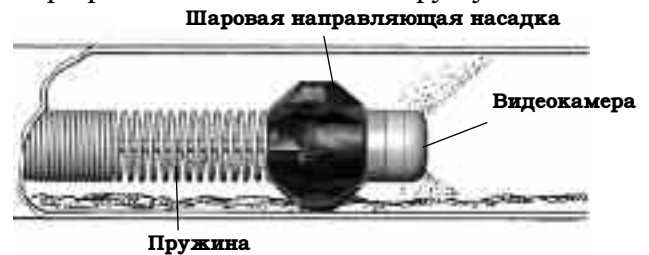
Рис. 16 – Положение шаровой направляющей насадки при работе
