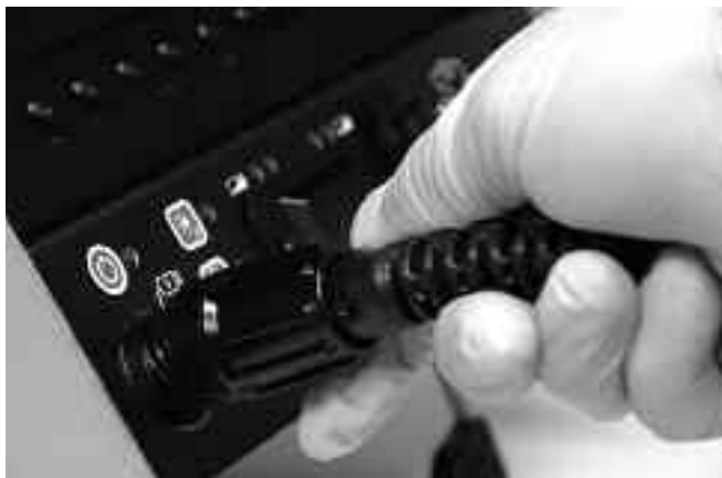
Рис. 17 – Подсоединение к блоку CCU SeeSnake
