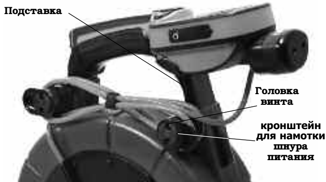
Рис. 13 – Опорная подставка и кронштейн катушки шнура питания
