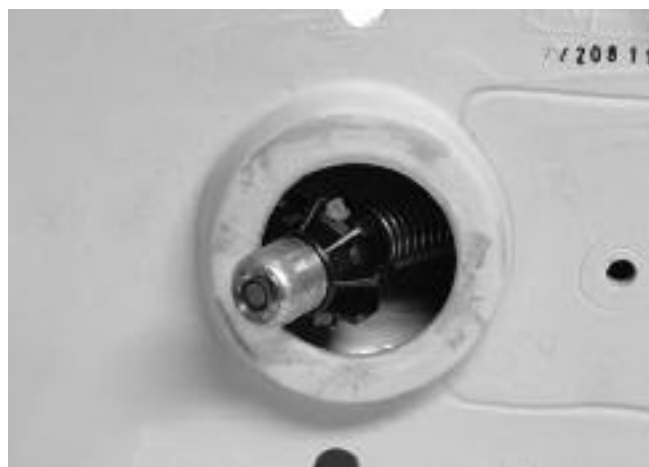
Рис. 21. Головка камеры с шариковой направляющей при прохождении поворота
