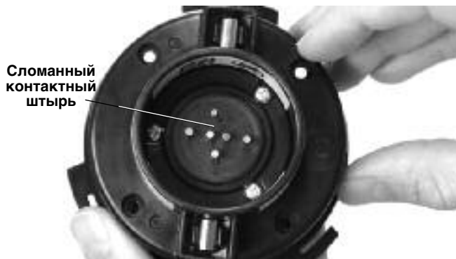
Рис. 7. Сломанный контактный штырь
