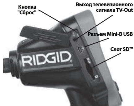
Рис. 4 - Крышка гнезд с левой стороны прибора
