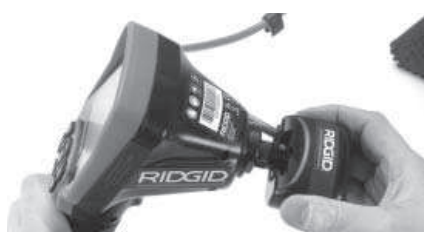
Рис. 19 - Вилка разъема видеокамеры подключена
