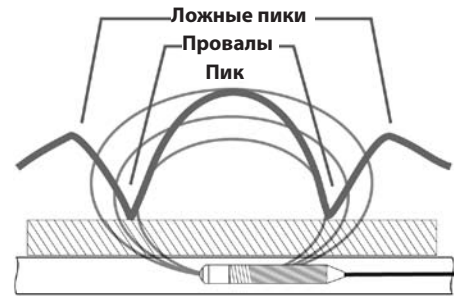
Рис. 35: Сигнал от зонда, который "видит" традиционный трассоискатель
