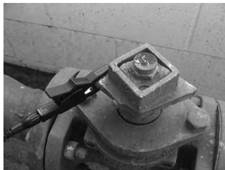
Рис. 7: Соединение прибора ST-305 с магистралью
